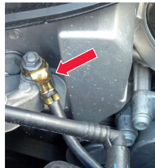
Εικόνα 3: Το καλώδιο γείωσης πρέπει να ελέγχεται ως προς την έδρασή του και για πιθανές φθορές.
