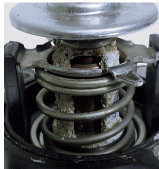
Abbildung 2: Durch nicht freigegebene Kühlmittelzusätze wird das Aluminium regelrecht zersetzt.
