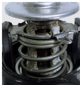
Figura 2: Un refrigerante incorrecto puede provocar incluso una descomposición del aluminio.
