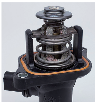
Figure 1 : Traces de corrosion évidentes sur un thermostat cartographique (type TM).
