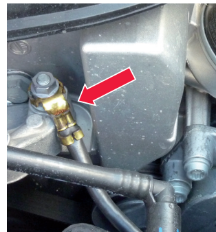
Abbildung 3: Das Massekabel muss auf korrekten Sitz und Beschädigungen geprüft werden.
