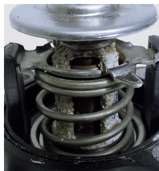
Figure 2 : Les additifs non agréés par le constructeur rongent l'aluminium jusqu'à le décomposer.
