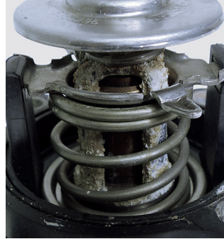
Resim 2: Onay verilmemiş soğutma sıvısı katkıları nedeniyle alüminyum düzenli olarak ayrıştırılır.
