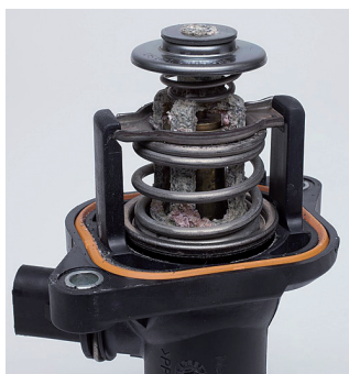
Ilustracja 1: Wyraźne ślady korozji na termostacie fazowym (typu TM)
