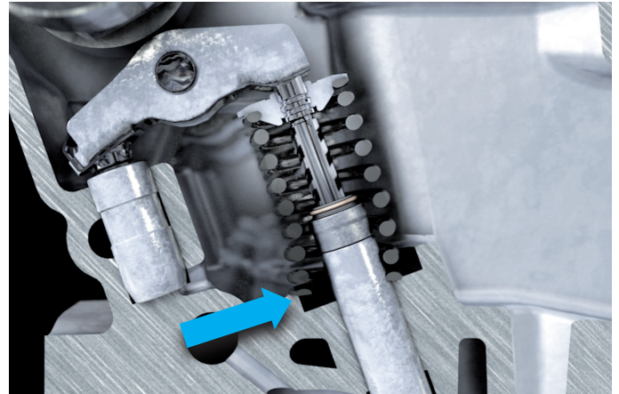
Zdjęcie 1: Ukośnie osadzona sprężyna zaworu
