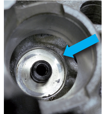
Resim 3: Silindir kapağındaki baskı izleri
