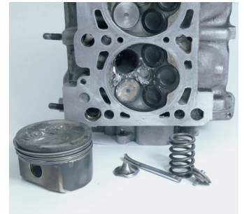
Resim 5: Bir supap kırıldıktan sonra oluşan tipik hasar tablosu
