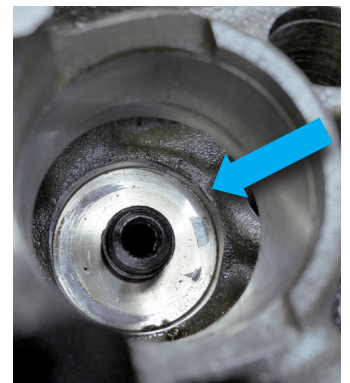
Εικόνα 3: Σημάδια πίεσης στην κυλινδροκεφαλή
