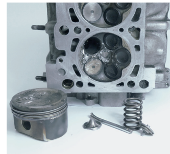
Рисунок 5: Типичная картина повреждения вследствие срыва клапана
