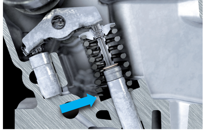
Resim 1: Eğik yerleştirilmiş supap yayı
