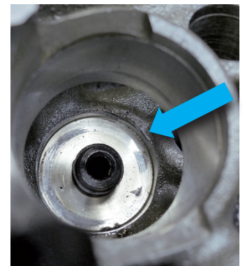
Figure 3 : Traces de pression dans la culasse
