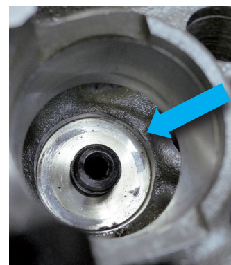
Рисунок 3: Следы неравномерной нагрузки в головке блока цилиндров
