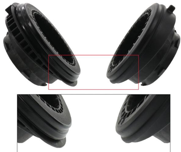
Bild 1: Federbeinstützlager mit Spritzschutz (links) und ohne (rechts)
