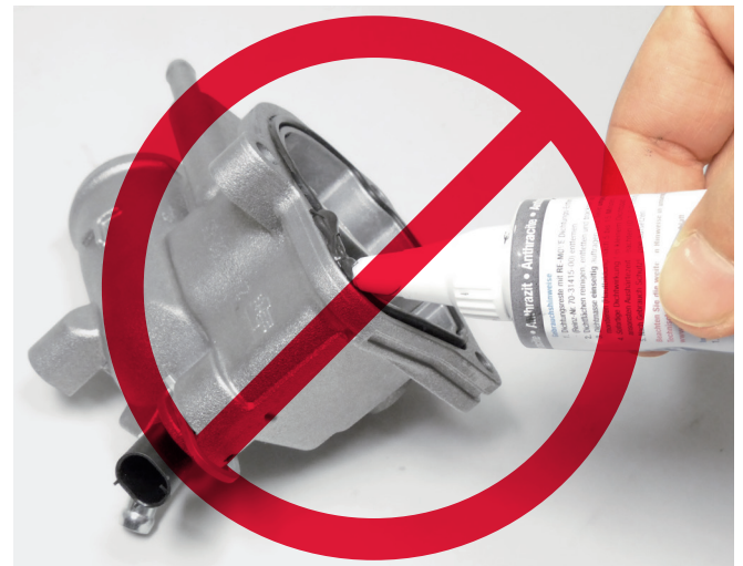
Εικόνα 3: Τα πρόσθετα στεγανωτικά μπορεί να προκαλέσουν ζημιά στις φλάντζες και να περιορίσουν τη λειτουργία.
