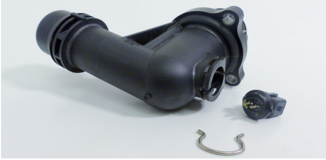
Resim 1: Tespit klipsleri çözülmüş ve bağlantısı yerinden sökülmüş elektronik kontrollü termostat
