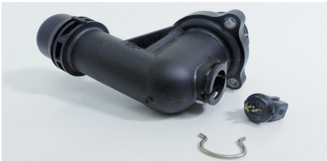
Abbildung 1: Kennfeldthermostat mit gelöster Halteklammer und abgerissenem Anschluss
