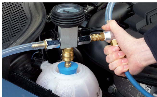
Рисунок 3: Вакуум в системе образуется за счет эффекта Вентури.
