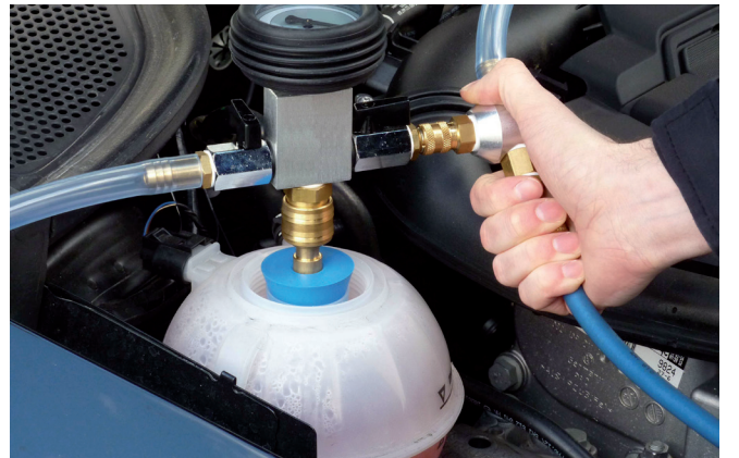
Resim 3: Venturi etkisi aracılığıyla sistemde bir vakum oluşur.
