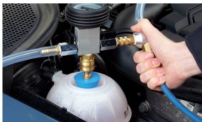
Figura 3: Mediante el efecto Venturi se genera una presión negativa en el sistema.
