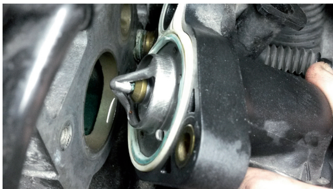
Figura 1: Cuando se abre el circuito de refrigerante, sale agua de refrigeración y entra aire en el sistema.
