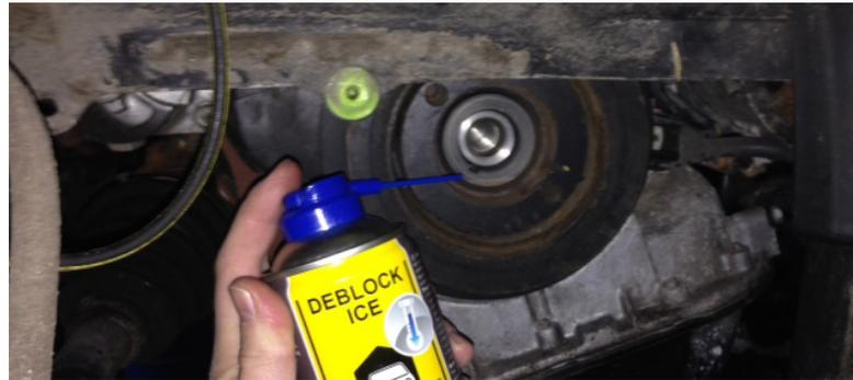
Viele Materialien, wie zum Beispiel Leichtmetalle, die werksoriginal immer öfter bei Autoteilen etc. eingesetzt werden, fressen sich nach einiger Zeit ein, wodurch eine Demontage der verrosteten Teile unheimlich schwierig wird.
