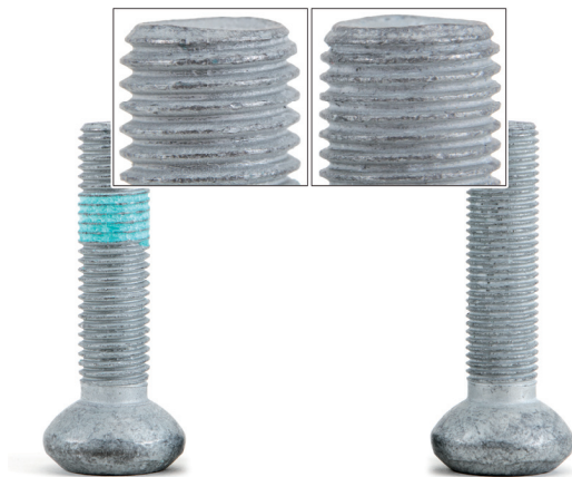
Bild 1: Linke Schraube: M12x1,5 Rechte Schraube: M12x1,25
