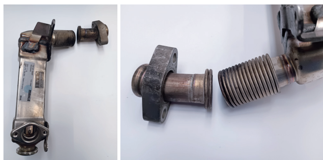
Иллюстрация 1: Радиатор РОГ с разорванный гибким шлангопроводом
