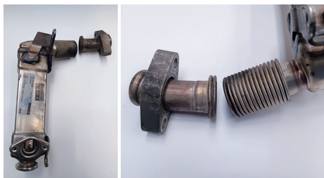
Figure 1 : Refroidisseur des gaz d'échappement avec tuyau flexible fissuré
