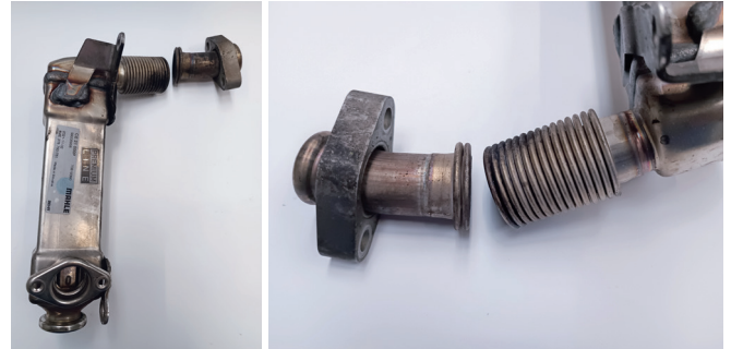
Εικόνα 1: Ψύκτης καυσαερίων με διαρρηγμένο εύκαμπτο σωλήνα
