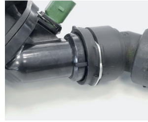
Resim 1: Termostat gövdesindeki hızlı bağlantı tertibatı
