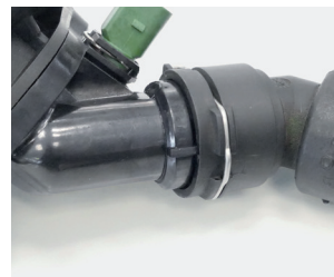
Εικόνα 1: Ταχυσύνδεσμος στο περίβλημα θερμοστάτη
