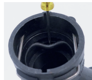
Иллюстрация 2. Извлечь изношенное уплотнение фланца при помощи специального инструмента и заменить его
