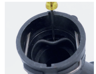
Εικόνα 2: Αφαιρέστε τον παλιό στεγανοποιητικό δακτύλιο στη φλάντζα με κατάλληλο εργαλείο και αντικαταστήστε
