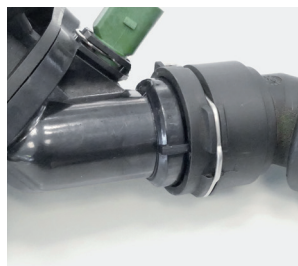
Иллюстрация 1. Быстроразъемное соединение на корпусе термостата
