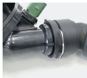
Figure 1 : Système de fermeture rapide sur le boîtier du thermostat
