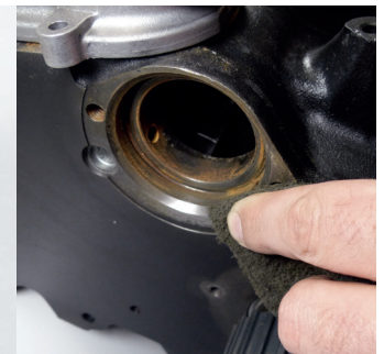
Εικόνα 3: Καθαρίστε σχολαστικά τις διαβρωμένες επιφάνειες πριν από τη συναρμολόγηση
