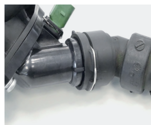
Ilustracja 1: Szybkozłącze na obudowie termostatu
