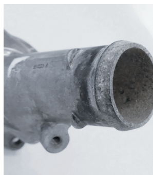
Иллюстрация 3. Перед сборкой тщательно очистить поверхности со следами коррозии.
