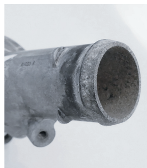
Figure 3 : Nettoyez soigneusement les surfaces rouillées avant l'assemblage
