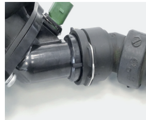
Abbildung 1: Schnellverschluss am Thermostatgehäuse
