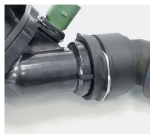
Figura 1: Conector rápido en la carcasa del termostato
