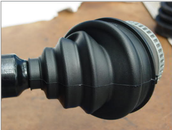
Bild 1 – Manschette zu weit aufgeschoben
