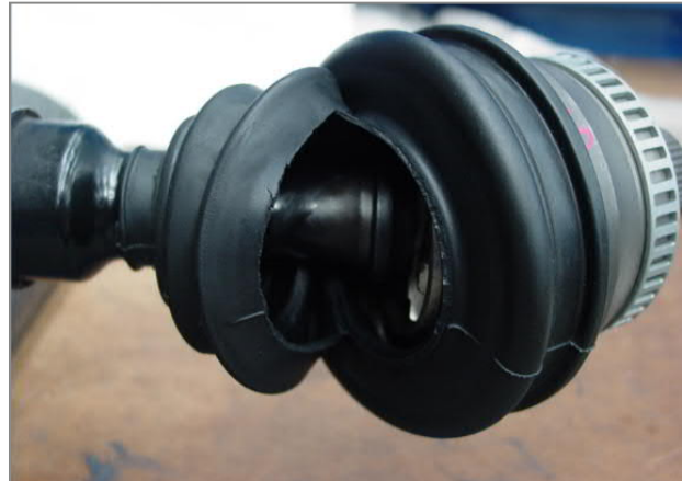
Bild 2 – Manschette reißt in den Lamellen ein
