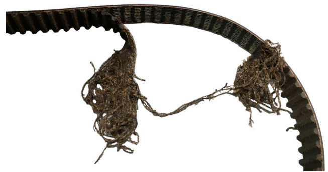
Bild 1: Zahnriemen mit abgelöstem Zahngewebe
