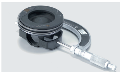
Εικόνα 2: Η επίστρωση προσθέτει περίπου 0,03 mm έως 0,04 mm στην καθορισμένη διάμετρο
