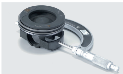
Иллюстрация 2: Покрытие добавляет ок. 0,03...0,04 мм к указанному диаметру
