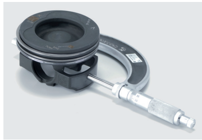
Resim 2: Kaplama, belirtilen çapa yaklaşık 0,03 mm ile 0,04 mm ekler
