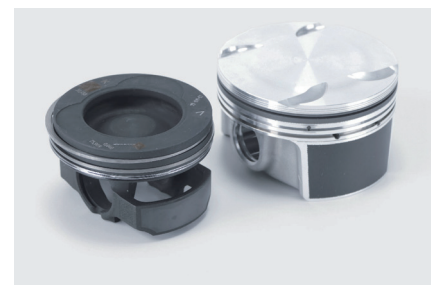
Figura 3: El recubrimiento oscuro no está visible en los pistones de acero negros
