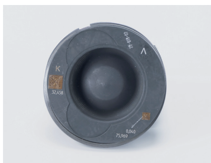
Abbildung 1: Kolbenmaß, Einbauspil und Einbau-richtung stehen auf dem Kolbenboden
