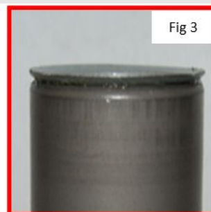
Rys. 3: Pierścień ustalający tłoka jest zdeformowany lub pofalowany. Oznacza to, że cylinder został nadmiernie obciążony.
