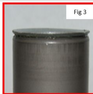
Le jonc d'arrêt présente une déformation ou une ondulation. Cela indique une sur-course.
