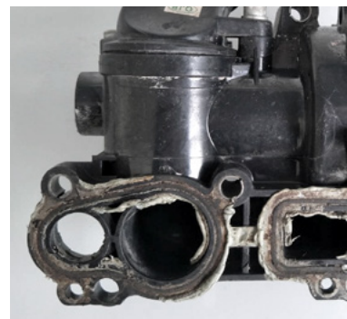
Abb. 5: Undichtigkeiten durch zusätzliche Dichtmittel (Schadensbild)
