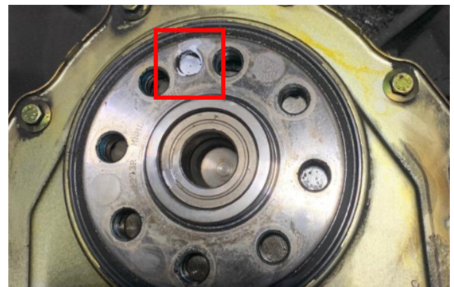
Bild 2: Bezugsmarke der Kurbelwelle
