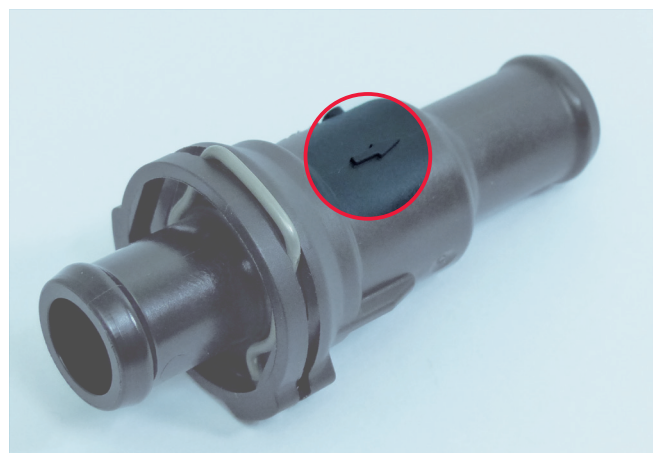
Εικόνα 2: Σημαντικό κατά την αλλαγή του θερμοστάτη: Προσοχή στη φορά τοποθέτησης (βέλος)!
