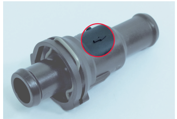
Figura 2: Importante al sustituir el termostato: ¡tener en cuenta la dirección de montaje (flecha)!
