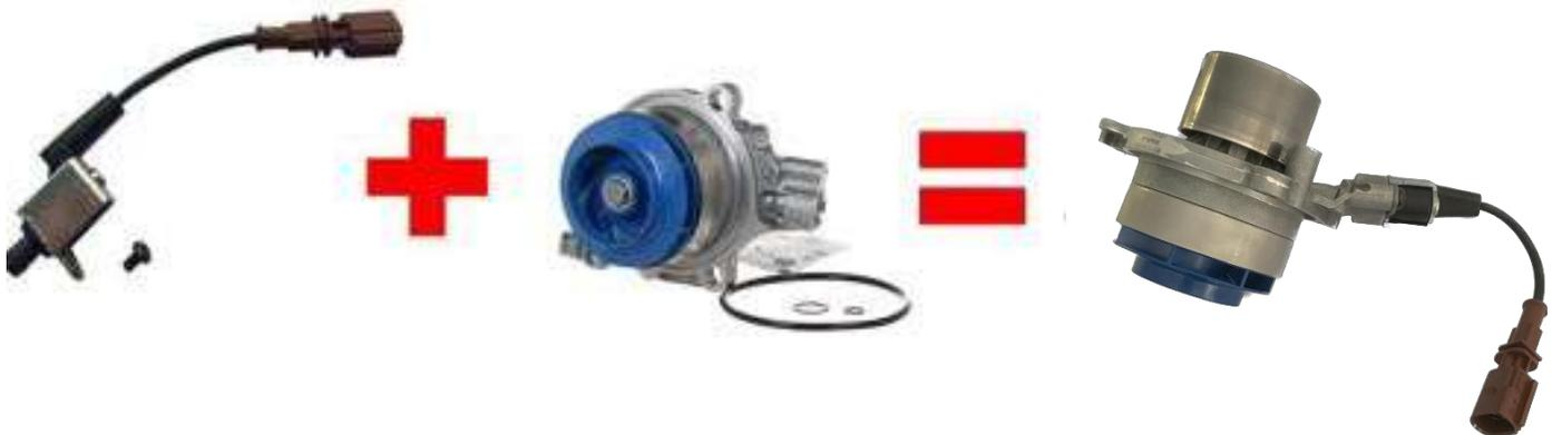
**HINWEIS** : Wenn das Betätigungselement nicht korrekt eingebaut ist, können ein Fehlercode und eine Warnleuchte im Armaturenbrett des Fahrzeugs erscheinen!
