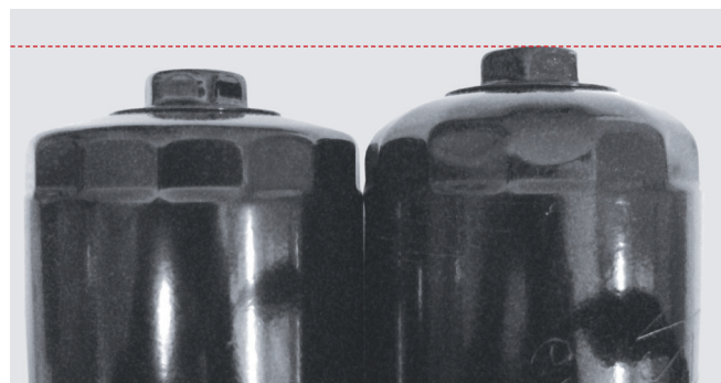
Ilustracja 3. Bezpośrednie porównanie filtrów oleju – po lewej: stan normalny, po prawej: zdeformowany
