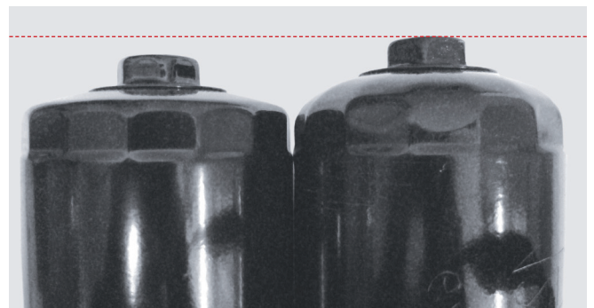
Figure 3 : Comparatif de deux filtres à huile : à gauche en état normal, à droite déformé
