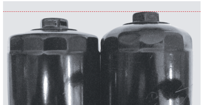
Abbildung 3: Ölfilter im direkten Vergleich – links Normalzustand, rechts deformiert
