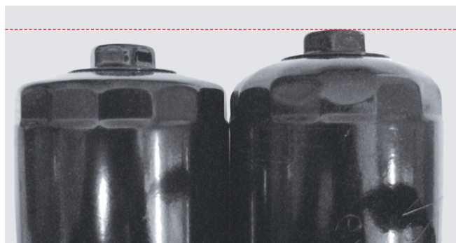
Рисунок 3: Нормальный масляный фильтр (слева) и деформированный масляный фильтр (справа)
