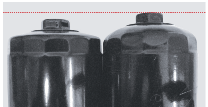
Εικόνα 3: Φίλτρο λαδιού σε απευθείας σύγκριση - αριστερά: Κανονική κατάσταση, δεξιά: παραμορφωμένο
