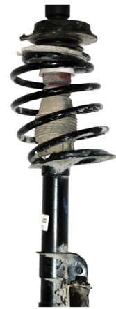
Falsch montierte Kopfplatte
