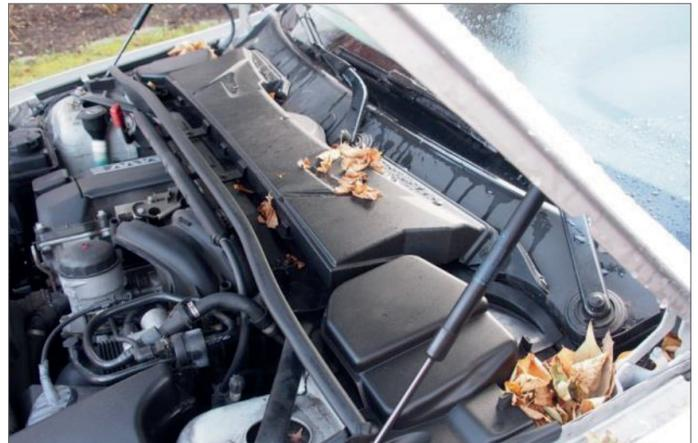
Solche Fehler sind jedoch in aller Regel nicht reklamationsfähig. AIC- Wischermotoren sind, ebenso wie die OE-Teile, nur **spritzwassergeschützt**, nicht jedoch **wasserdicht** konstruiert.
