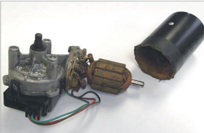
Immer wieder erreichen uns Reklamationsfälle von Wischermotoren, wie auf dem Foto links zu sehen. Schon von außen ist deutlich erkennbarer Rost vorhanden und die Fehlerbeschreibung zeigt in aller Regel mindestens eine Schwergängigkeit des Motors.
