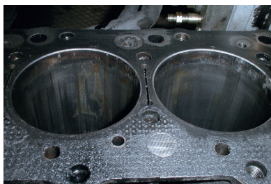
Иллюстрация 2: Царапины на рабочей поверхности цилиндра
