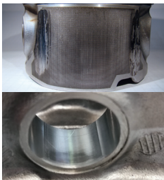
Εικόνα 1: Ίχνη φθοράς στον άξονα εμβόλου και στην οπή πλήμνης
