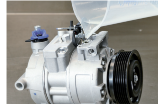
Resim 2: Kompresörü öngörülen miktarda sistem yağı ile doldurun ve tekrar kapatın
