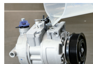
Zdjęcie 2: Napełnić kompresor przewidzianą dla danego systemu ilością oleju i ponownie zamknąć
