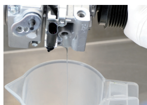
Figure 1 : Vider l'huile du nouveau compresseur et déterminer la quantité d'huile
