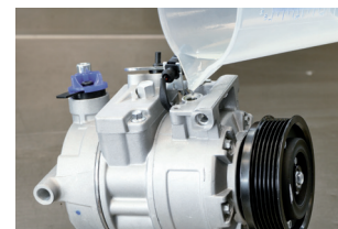
Рисунок 2: Заправить компрессор требуемым объемом масла и вновь закрыть его
