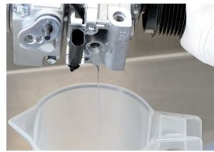
Figura 1: Purgar el aceite del nuevo compresor y calcular la cantidad de aceite
